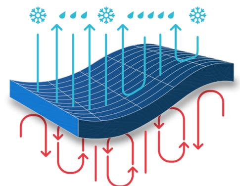
El THERMOLITE es un aislante térmico de bajo espesor y su función principal es retener el calor por mucho más tiempo que cualquier otra fibra. Mantiene el calor corporal aún en condiciones húmedas, ya que absorbe menos del 1% de su peso en agua, lo cual, permite trabajar en lugares húmedos.
